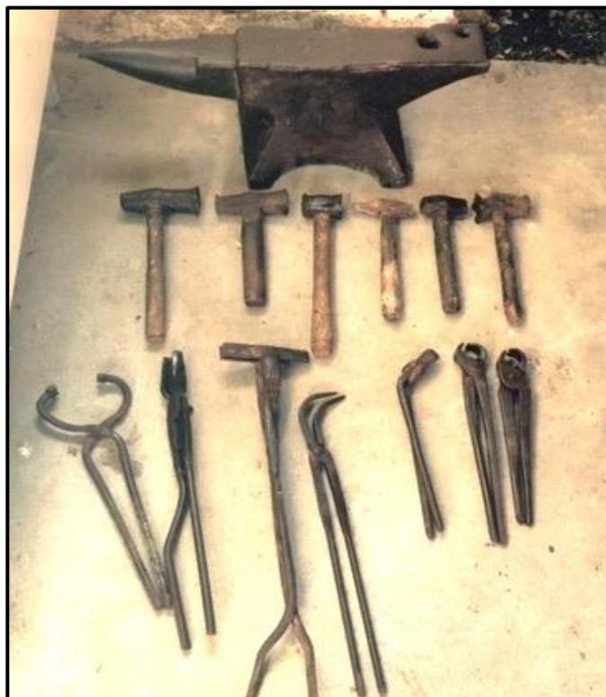
Ambolt fra smedjen i Tvis med tilpassede håndhamre og tænger til anvendelse ved fremstillingen af hestesko m.m.
