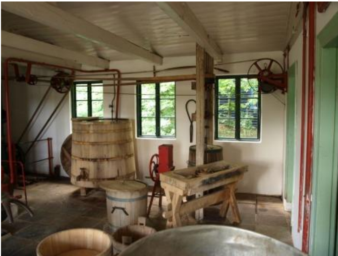
Figur 21. Maskineriet i andelsmejeriernes start. Her fra mejerimuseet på Hjerl Hede. Det kegleformede store trækar er en vandbeholder. Smørkærnen er den mindre kegleformede træbeholder bag stolpen.
